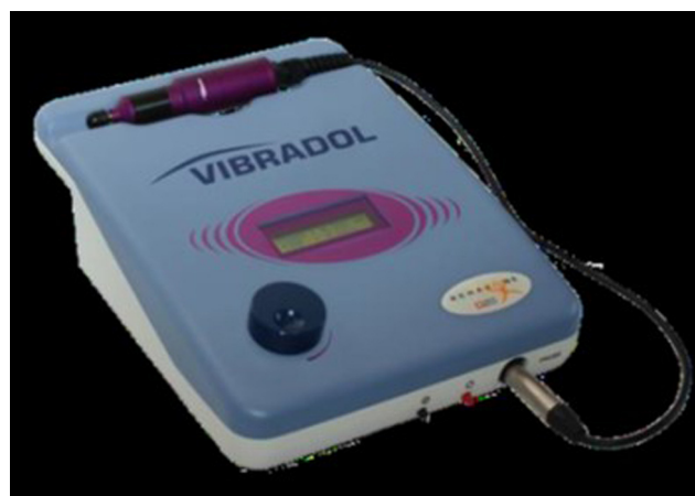
Figure 3. Générateur de vibrations mécaniques, fréquence maximale de 100 Hz.
